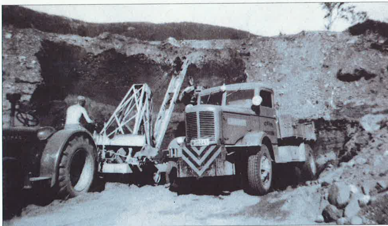
Ill. 15. Graver på ramme med enakslet hjulgang, tilkopleet traktor, mekanisk drevet og med wire-system. Svensk fabr. ABS, ca.1953. For øvrig på bildet Hanomag traktor og FWD 4x4 lastebil. Foto: Bjørn Hågensen.
