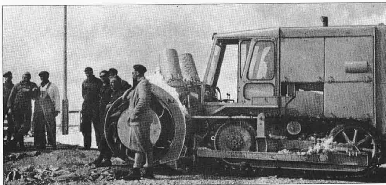
Ill. 22. Beltegående fres med samme type fresaggregat. Bygget på samme traktor grunnkomponent, med helbeltekonvertering. Fra Øveraasen brosjyre.
