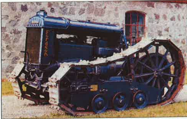
Ill. 10. Fordson-traktor 1936, med helbelte konvertering. Gjengitt fra svensk motorblad.
