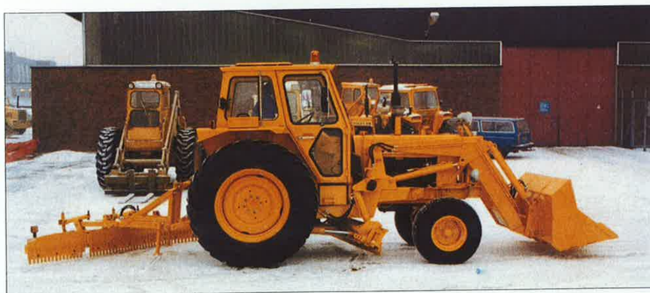
Ill. 24. Malm Orstad traktorhøvel, med basis Volvo BM T650 I traktor. 1976. Foto: B. Prebensen.
