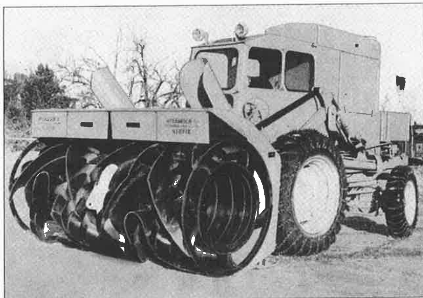
Ill. 21. Øveraasen hjulgående snøfreser, trommelfres type PEX-1200, ca. 1960. Bygget på traktor Fordson. Fra Øveraasen brosjyre.
