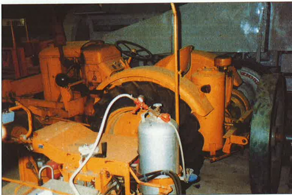
Ill. 14. Telemarks Deutz-traktor type F1L514 1953, 15 hk. Med kompressor. Foto: B. Prebensen.
