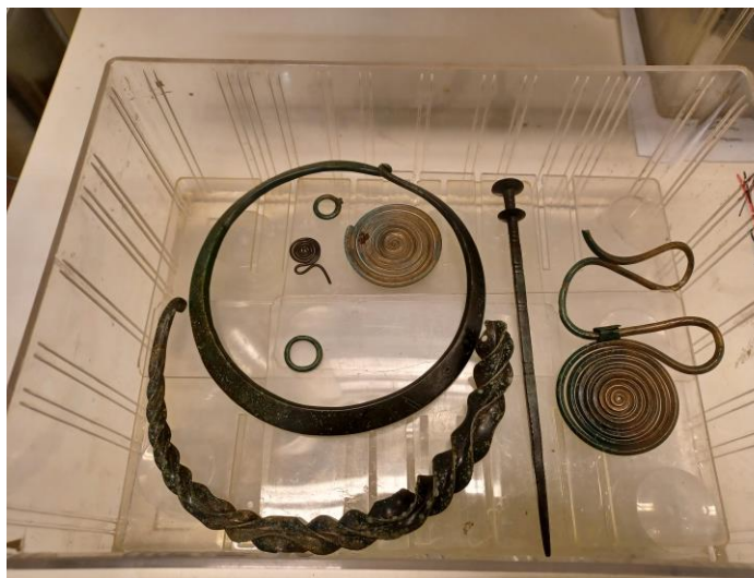
Bild 22. Föremålen placerades på en hylla i en plastlåda med vatten i botten. Lådan förslöts för att forcera fram en eventuell reaktion i materialet. Foto: Madelene Skogbert
