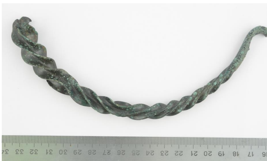
Bild 45. F2. Man kan se den vårtlika korrosionen som mer ljusblågröna fläckar. Foto: Madelene Skogbert
