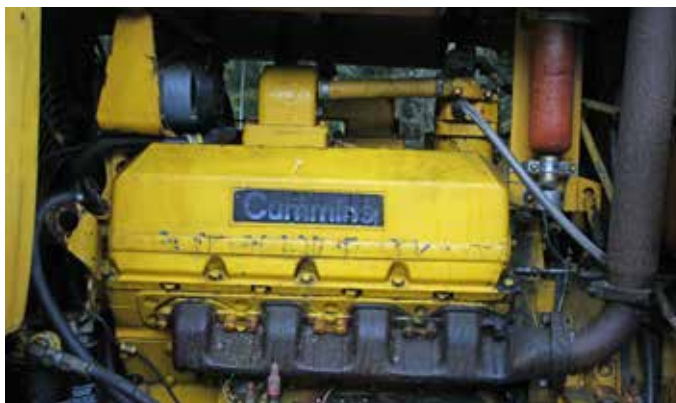
Motoren i lasteren er en Cummins-diesel V8, type V 504C 210, som yter 171 Hk
