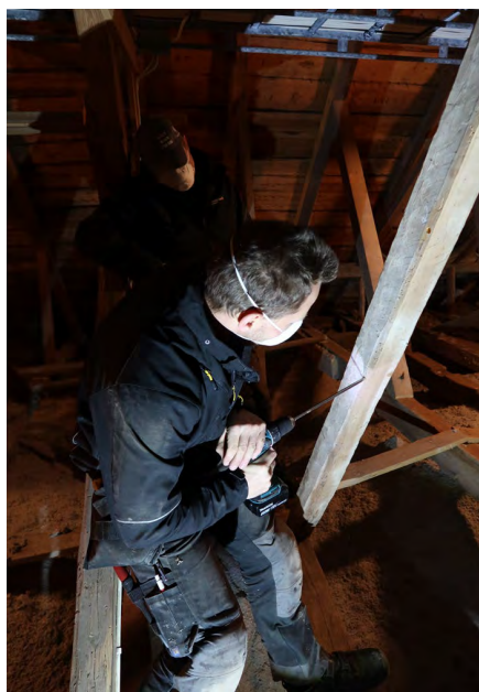
Borrhov tas i en av takstolarna inför dendrokronologisk undersökning.
