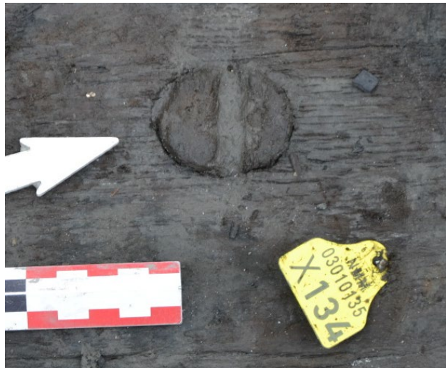
Figur 40: Eksempel på en kile på innsiden av en trenagle i band x134. Foto av Kristina Steen, NMM.
