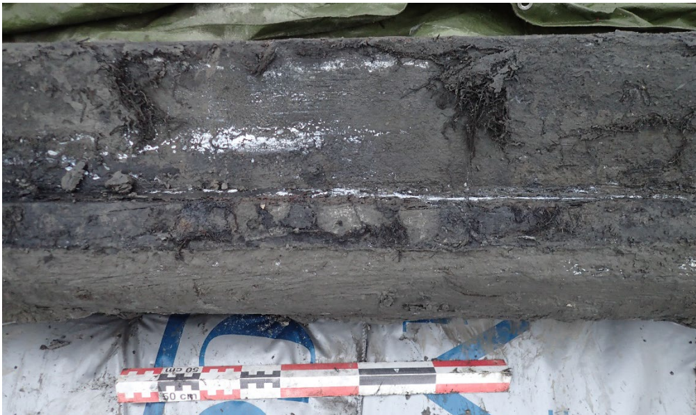
Figur 69: Ekstra smalere spinning på kjølen, på nedsiden av spinningen til kjølbordet. Foto av Kristina Steen, NMM.
