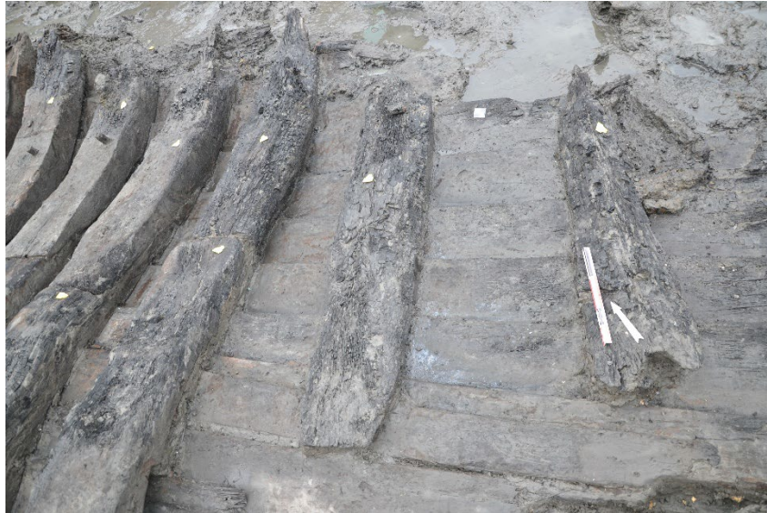
Figur 39: Brannskadede opplengere x168, x169 og x170 akter i Bispevika 4. Foto av Kristina Steen, NMM.
