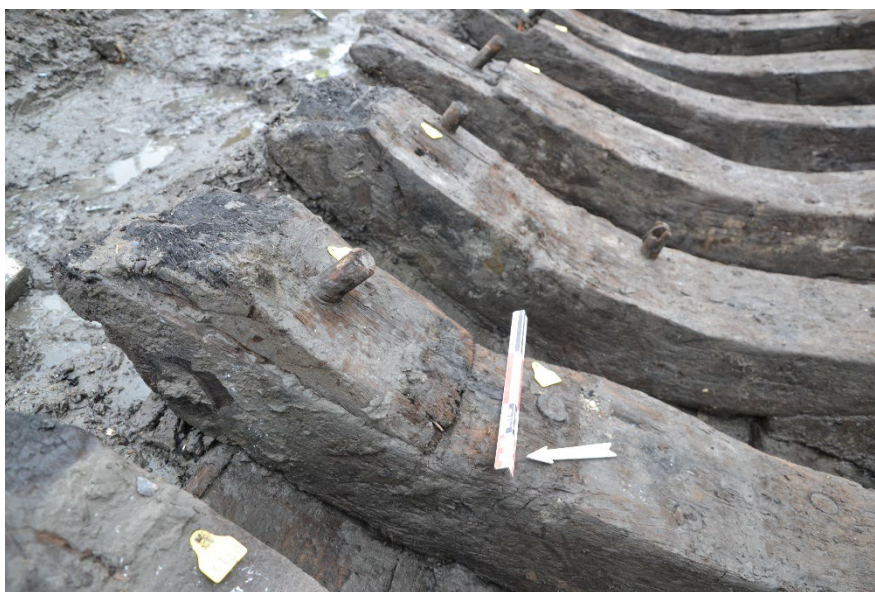
Figur 49: 2. opplenger x172, lasket over opplenger x159. Foto av Kristina Steen, NMM.
