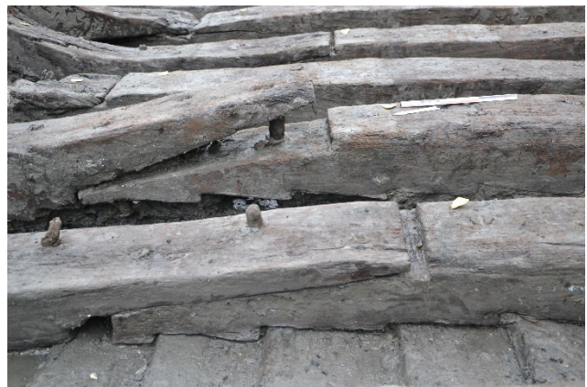
Figur 46: Eksempel på vertikalt lask mellom bunnstokk x135 og opplenger x153. Foto av Kristina Steen, NMM
