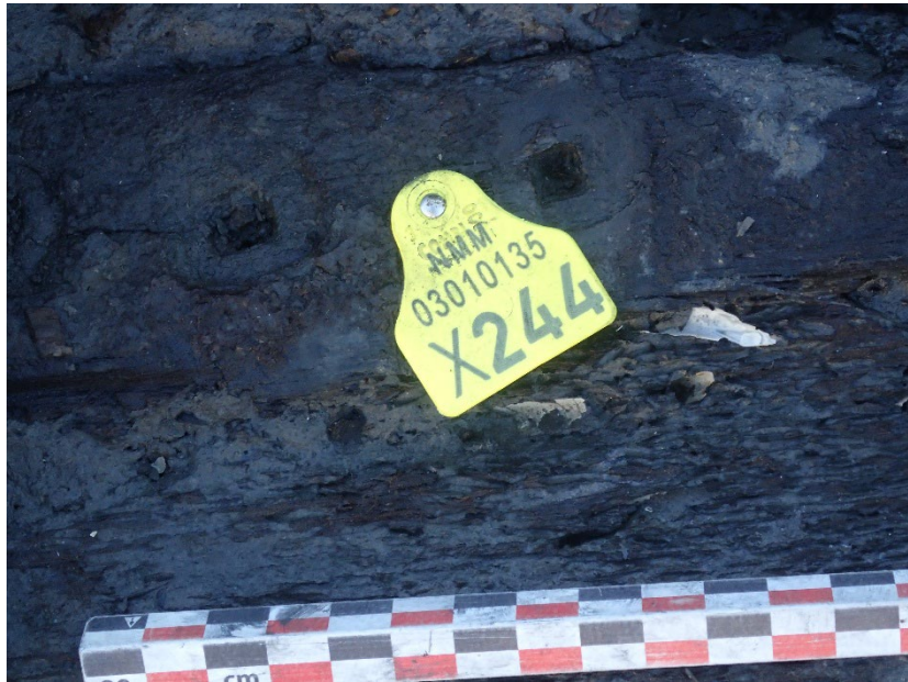
Figur 34: Eksempel på hudbord med spor etter angrep av pælekreps. Foto av Kristina Steen, NMM
