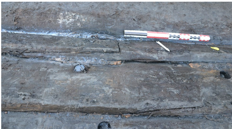
Figur 27: Eksempel på skaring sett ovenfra mellom hudbord x179 og x180. Foto av Kristina Steen, NMM.
