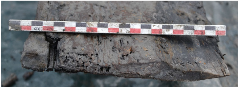
Figur 20: Eksempel på spor etter pølekrepsangrep på hudbord x029. Foto: Kristina Steen NMM.
