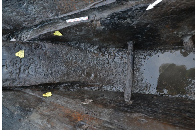
Figur 28: Trenagle mellom hudbord x137 og x143. Foto tatt mot SØ av Kristina Steen, NMM
