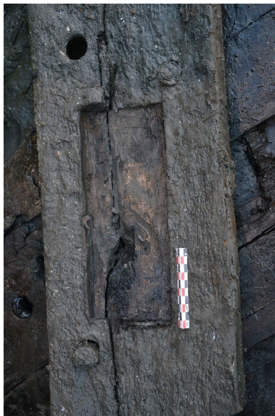
Figur 72: Firkantet område hugget inn i hudbord x134 for å feste reparasjonsdel x163. Foto av Marja-Liisa P. Grue, NMM
