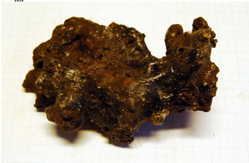
Fnr 59. Smidesslagg med insmält kvarts, troligen efter vällning, från ässjan/smedjan på norra sidan av Bölevägen.
