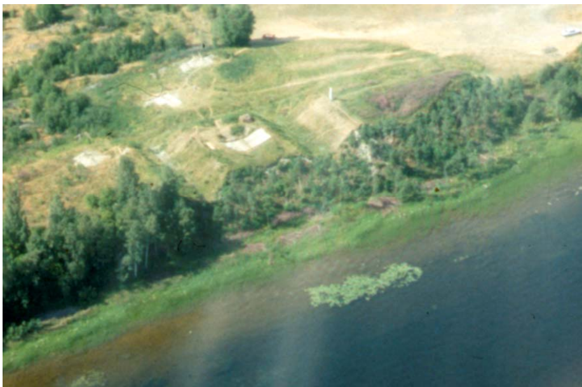
Flygbild över Styresholm från 1988. Rasvinkeln ut mot strandhaket ser ut att ha varit mindre brant för 20 år sedan. Foto. Jan Norman Riksantikvarieämbetet.
