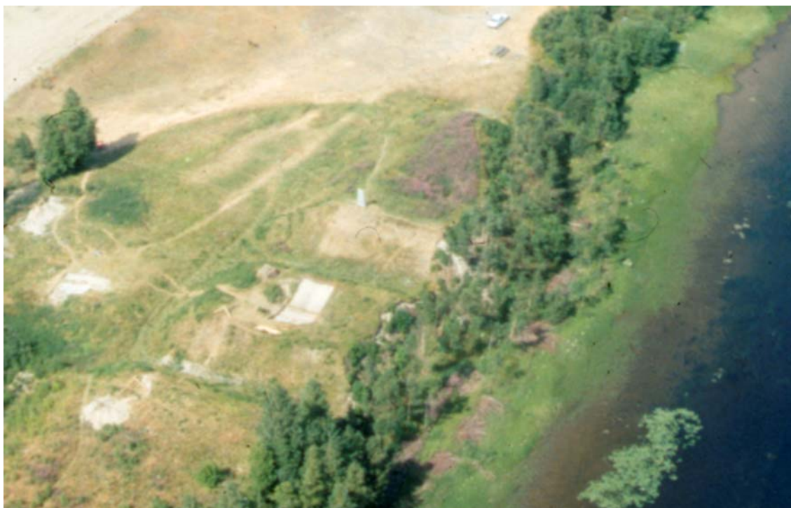
Flygbild över Styresholm från 1988. Rasvinkeln ut mot strandhaket ser ut att ha varit mindre brant för 20 år sedan. Genom att jämföra minnesstenens lägen på flygfotot och 2007 års inmätning framkommer att omkring 1 m an krönet eroderat bort på ca 20 år. Foto. Jan Norman Riksantikvarieämbetet.
