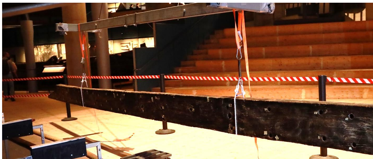
Figur 1. Bordplanka (PL-1) upphängd i två fjädrar på högkant.
