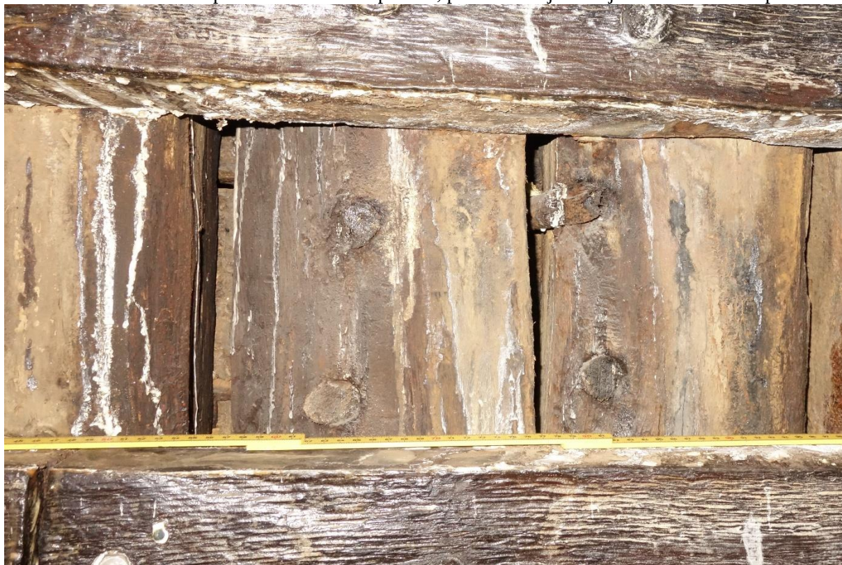
Bild 3. Del av det andra spantet för om kanonport 21, plus det tredje och fjärde för om kanonporten.
