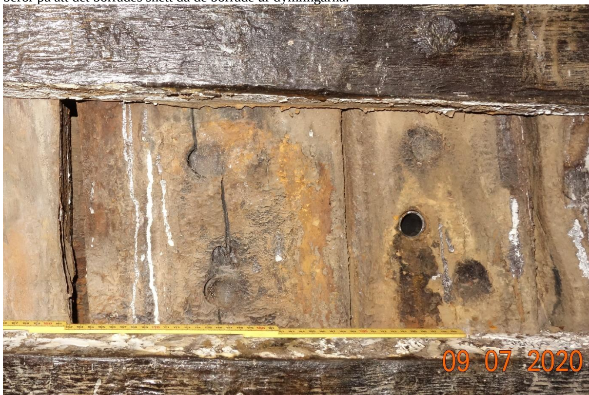
Bild 6. Det sjunde och åttonde spantet för om port 21. Det svarta märket mellan de två dymlingarna är beror på att det borrades snett då de borrade ur dymlingarna.
