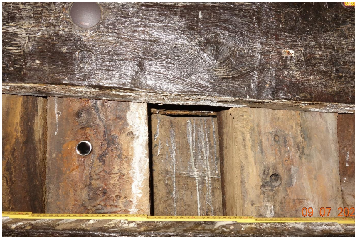
Bild 4. Det femte och sjätte spantet för om kanonport 21. Spikhålet i spant sex syns tydligt snett ovanför d:8.
