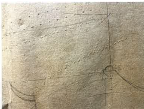
Bakside - hull etter oppmerking
