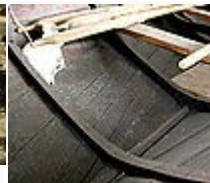
Her viser bordgangane i framsiden av båten. At bordgangane i botnen går på skrå, snid, er det som gir namnet, snidbetning. Bildet er teke på Norsk Marint Museum.
