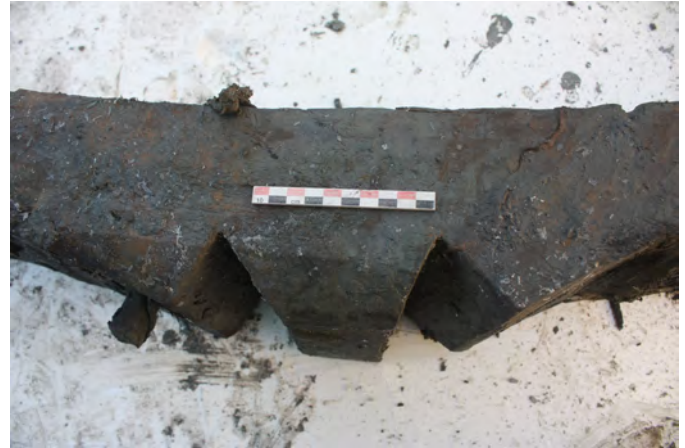
FIGUR 19 UNDERSIDE AV BUNNSTOKK MED VÅGRISS PÅ HVER SIN SIDE AV MIDTEN. FOTO: KHM
