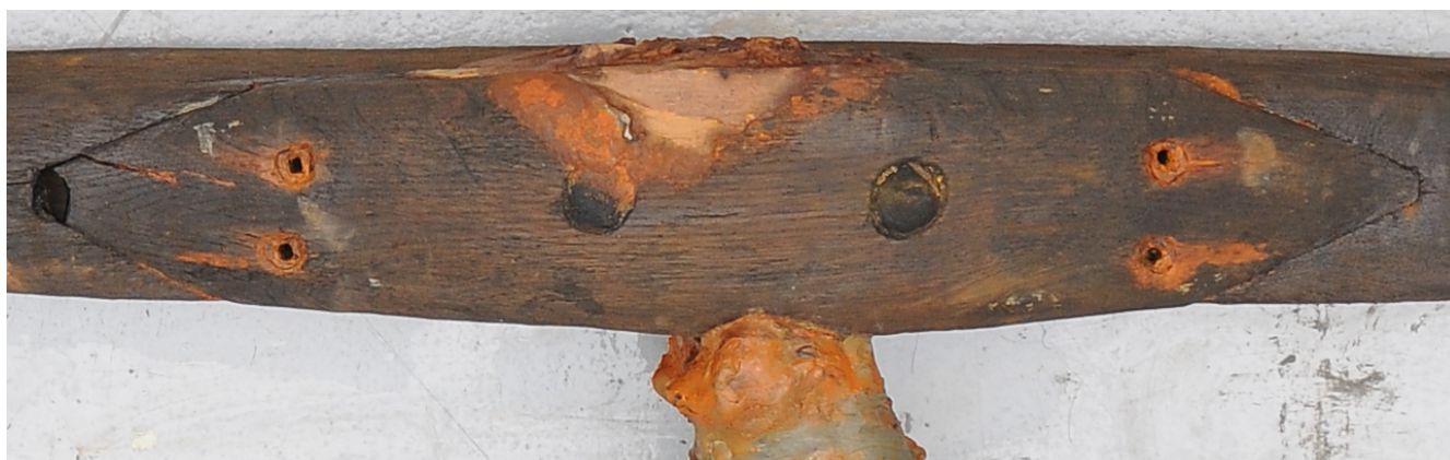
FIGUR 36 KLAMPEN VAR FESTET PÅ HOVEDDELEN AV ANKERSTOKKEN MED FIRE JERNSPIKER OG TO TRENAGLER. FOTO: NMM
