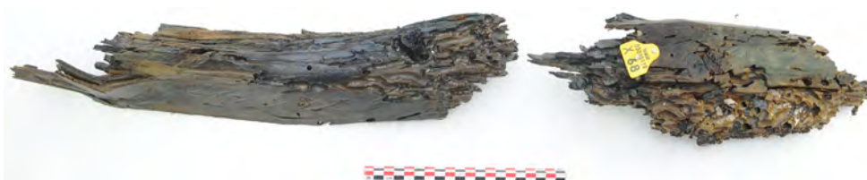
FIGUR 40 BAND x68 SOM ER KRAFTIG SPIST AV PELEMARK. FOTO: NMM
