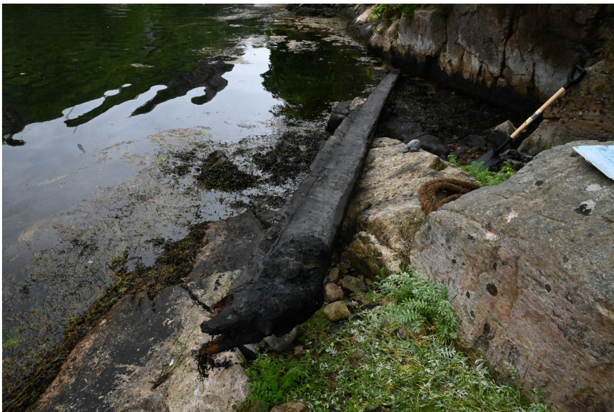
Fig. 5 Foto av kjølen der den ble tatt på land for nærmere gransking. Akterenden er nærmest i bildet. Foto: Tori Falck/NMM
