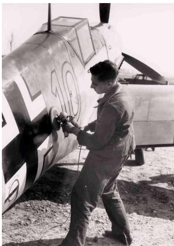
Overflaten poleres for å minske luftmotstanden.
