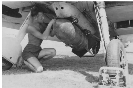
Festepunktet for dropptanken kunne også brukes til å montere en 250 kg SC bombe.
