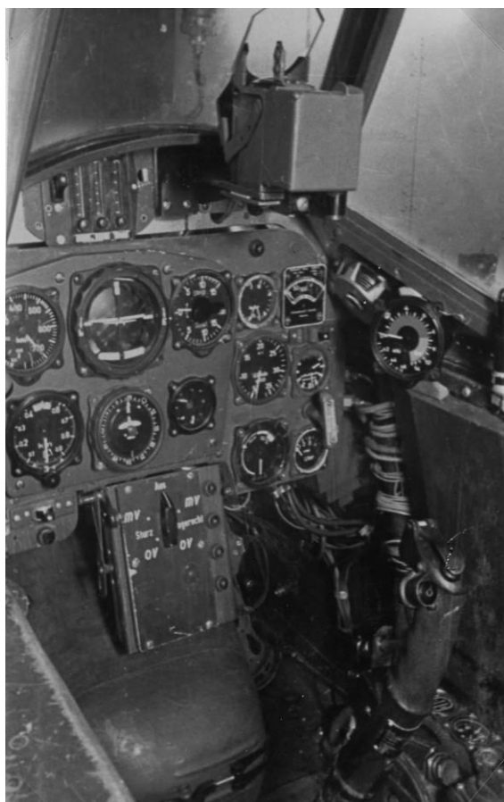
Cockpit i Bf-109 med våpensiktet øverst i bildet.
