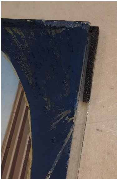
Figur 3: Cellplastbitar för att avlasta kanterna.
