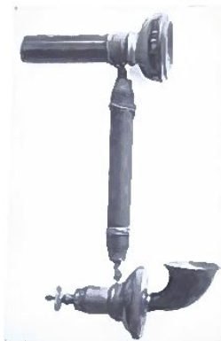
Fig. 9. Den första svenska mikrotelefonen, hopsatt 1894 av Lundqvist (Stockholms allmänna telefonaktiebolag).
